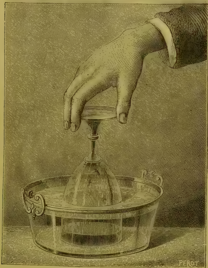
Fig. 22. Esperimento della campana del palombari eseguito con un bicchiere a calice ed un recipiente di vetro pieno d'acqua.
